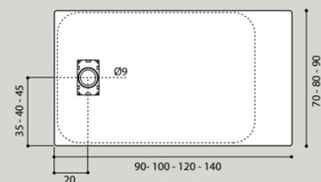
L'innovazione principale dei piatti doccia della Serie ECO è la sua estrema leggerezza dato dal materiale utilizzato, l'SMC un materiale in poliestere rinforzato con fibre di vetro, un prodotto più resistente del marmo, ma meno fragile e più facile da posizionare, in ogni forma e dimensione.
